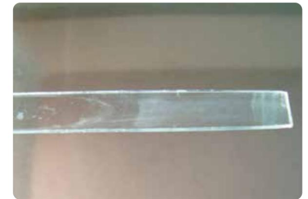
Figura 1. Dispositivo de vidrio con biopelícula en su superficie después de un energético lavado.
